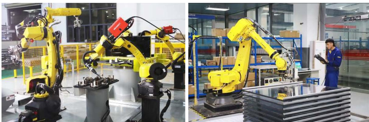
智能化自动焊接、自动打胶生产线
